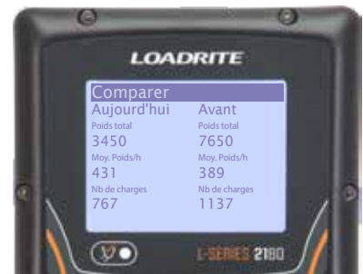
Les données de performances sont stockées pour que le conducteur puisse les comparer à la meilleure période de travail, à la moyenne, aux données précédentes
